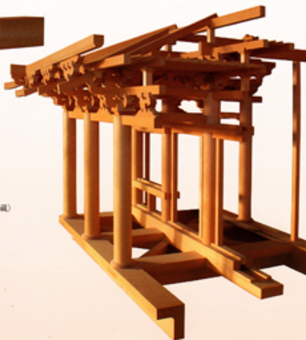
部材の納まりを確認するための部分模型(船工舎製作)
